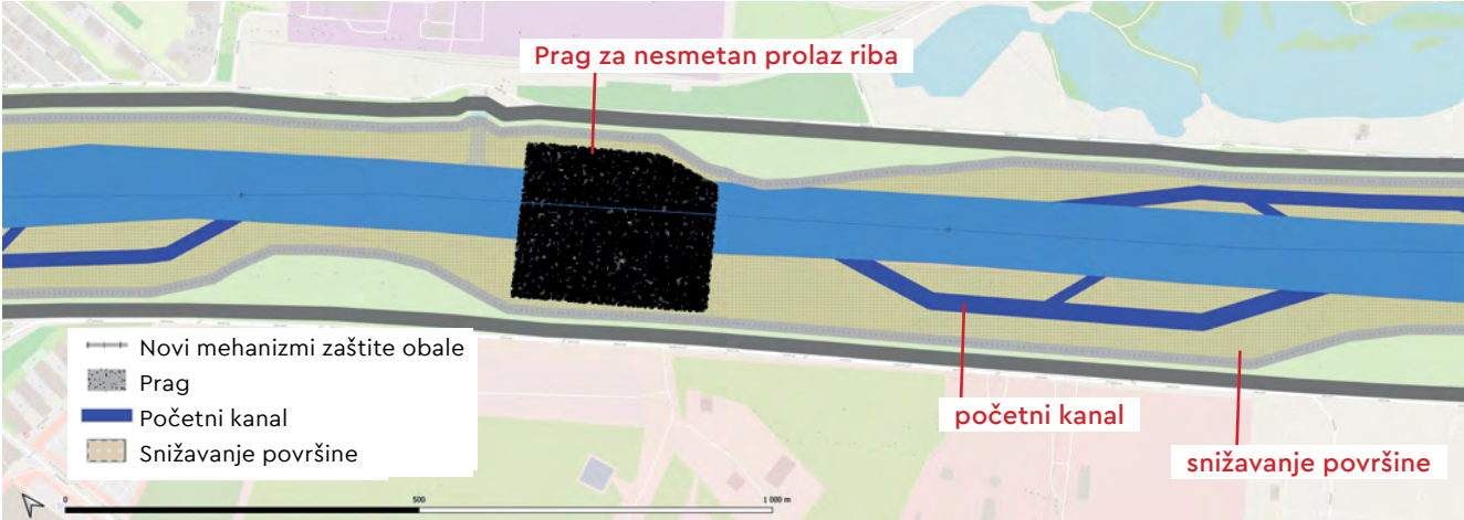
Slika 39: Prijedlog inicijalnih mjera na Savi na lokaciji kod postrojenja HEP - Toplinarstvo.
