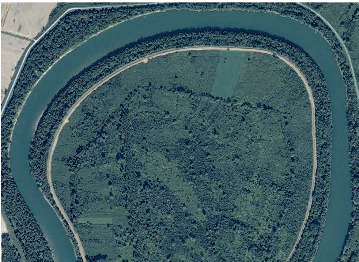
□ Slika 118: Područja poplavne nizine odvojena nasipima za obranu od poplava unutar krivina meandara omogućuju odlične i ekonomične uvjete za ponovno spajanje s rijekom (uzvodno od Jasenovca, HR) [21].
