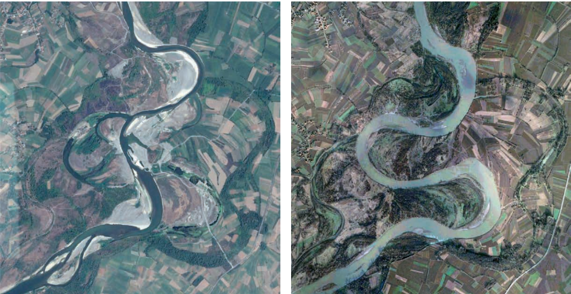
□ Slika 54. i 55: Primjer donjeg toka Bosne. Lijevo: stanje 2015., desno: stanje 2003. g. Intenzivno vađenje sedimenta uzrokovalo je degradaciju riječnog kanala. [21].
